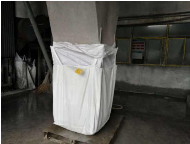
固化后飞灰堆放点（■1）固体废物
